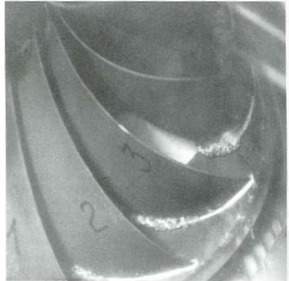
Fig. 9.16. Développement d'une cavité à l'entrée d'une roue de turbine Francis ( v = 0,500 ) (Avellan et al. 1993)
