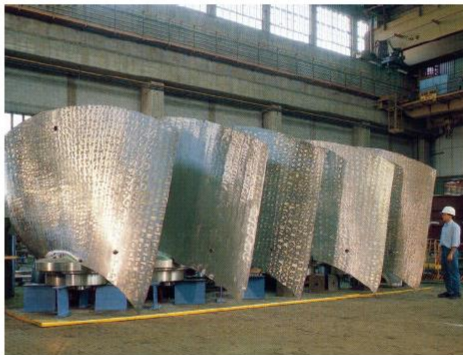
Girante Kaplan con palettature a calettamento variabile
