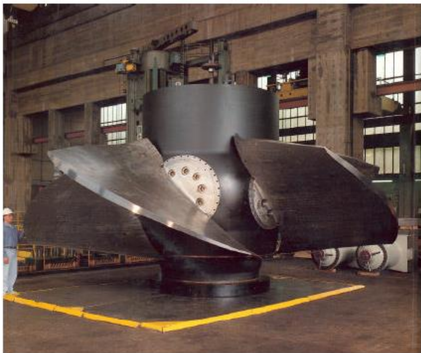
Girante Kaplan con palettature a calettamento variabile
